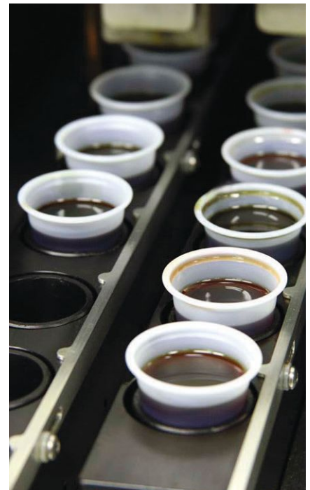
Figure 1 | CAV viscosity cups. (Photo courtesy of ALS Tribology.)
